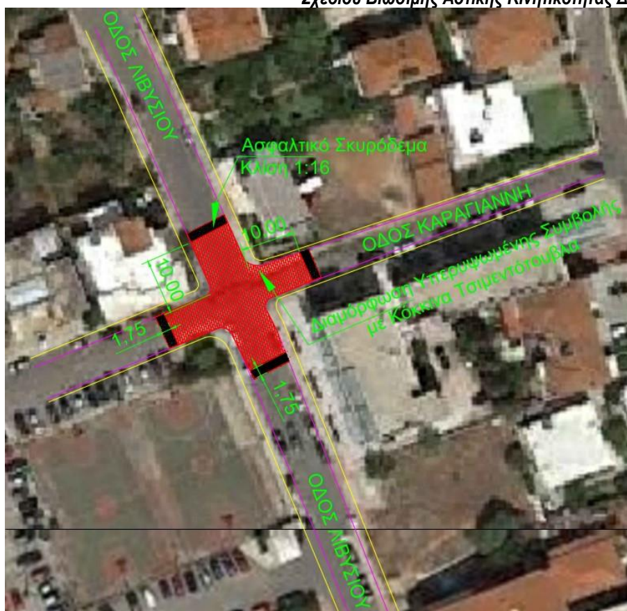
Χάρτης 16: Διασταύρωση οδών Καραγιάννη - Λιβυσίου - Υπερυψωμένη συμβολή (πλατό).
