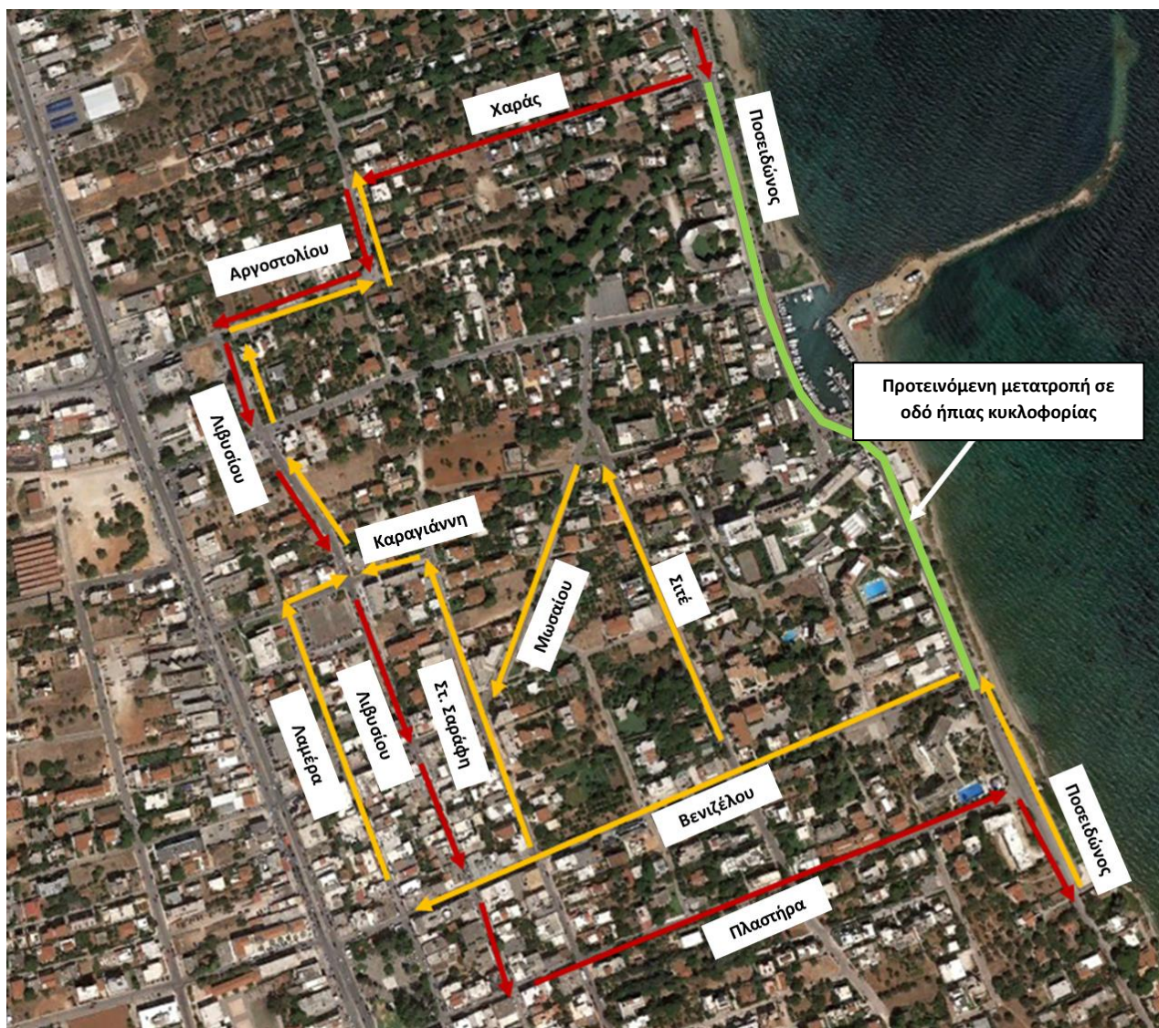
Εικόνα 24: Προτεινόμενη μετατροπή οδικού τμήματος Ποσειδώνος σε οδό ήπιας κυκλοφορίας – παράλληλη εξυπηρέτηση διαμετερούς κυκλοφορίας
